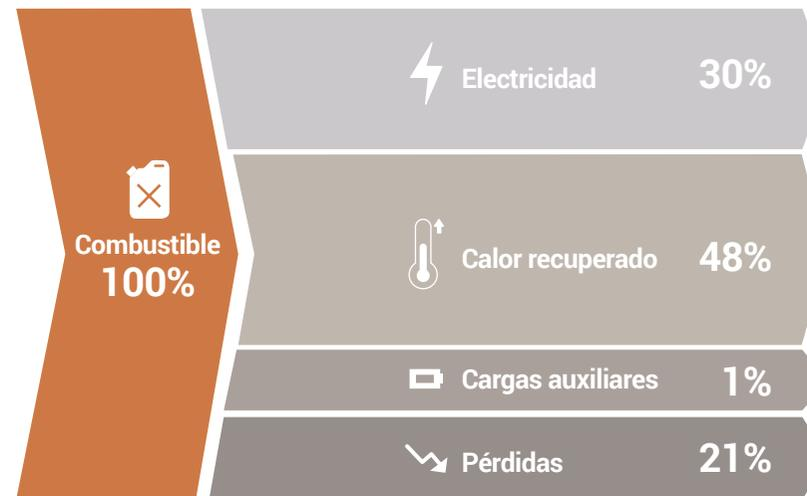
La potencia eléctrica de las turbinas a gas es corregida para condiciones de operación superiores a 15°C y 0 m de altitud, por lo cual es necesario consultar al proveedor la potencia real según el lugar de la instalación. Adicionalmente, las turbinas a gas pierden eficiencia eléctrica a lo largo de su vida útil con lo cual aumenta el calor que puede ser recuperable.
