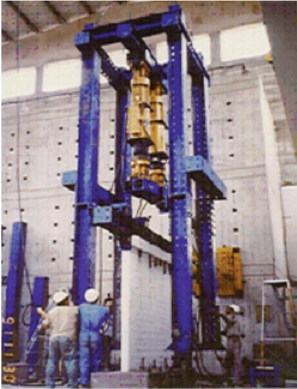
Figura 6.9 Ensayo en muro de reacción del Centro Peruano Japonés de Investigaciones Sísmicas y Mitigación de Desastres (Fuente: Universidad Nacional de Ingeniería, Perú). http://www.cismid-uni.org/laboratorio-de-estructuras.html
