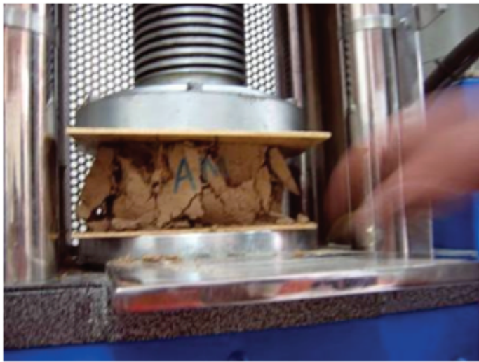
Figura 6.7 Laboratorio de estructuras del instituto de ensayos de materiales. Ensayos sobre elementos de adobe (Fotografía: FACARTE, Universidad Nacional de Colombia).
