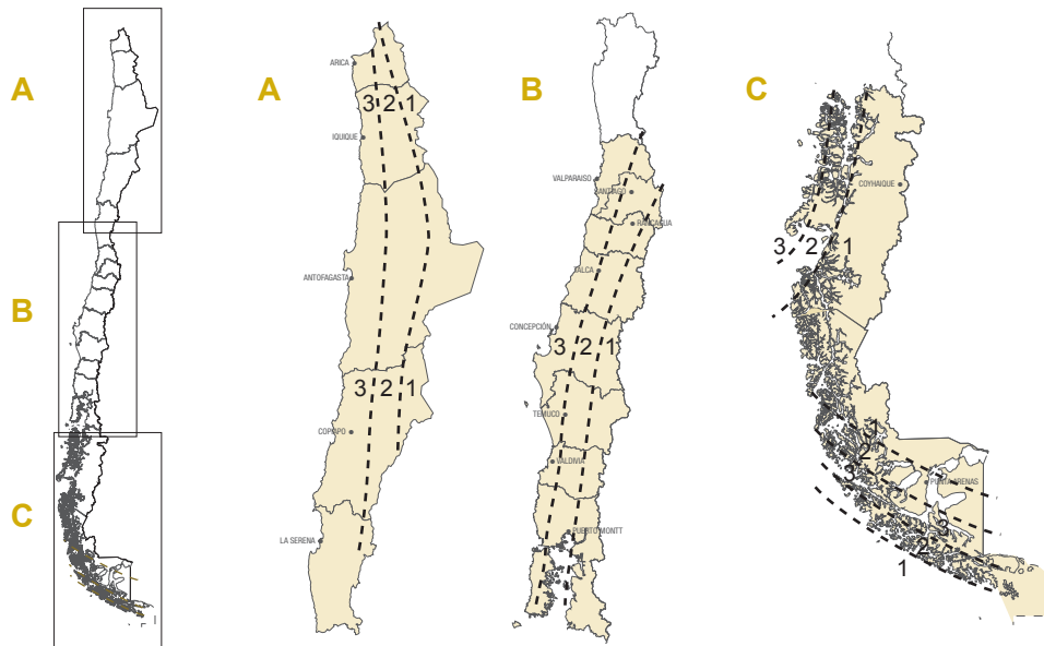
Figura B.3 Zonificación Sísmica de Chile (Fuente: normas Nch433 de diseño sísmico de edificios).
