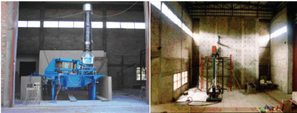
Figura 6.6 Ensayo dinámico y estático de estructuras y componentes en el Laboratorio del Instituto de Investigaciones Antisísmicas (IDIA), Universidad de San Juan, Argentina (Fuente: Francisco Crisafulli).
