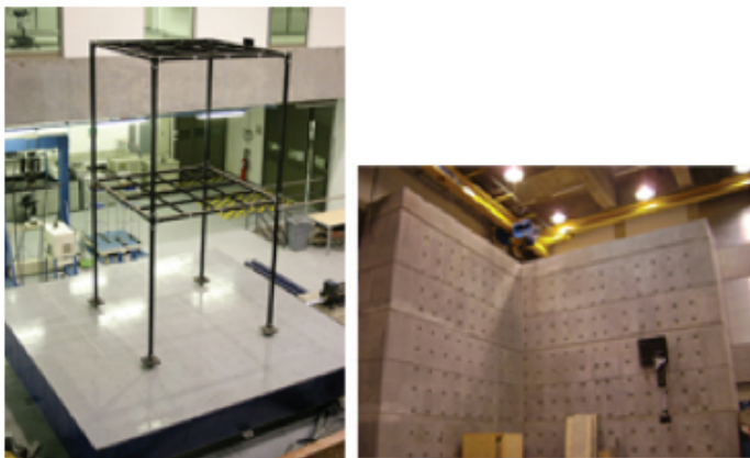
Figura 6.8 a) Placa y muro de reacción para ensayos con actuadores de 60 y 40 toneladas b) Mesa vibratoria de área 4,5 x 4,5 metros, para ensayos de estructuras de hasta 3 pisos (Fuente: Laboratorio Integrado de Ingeniería Civil y Ambiental de la Universidad de los Andes, Colombia).
